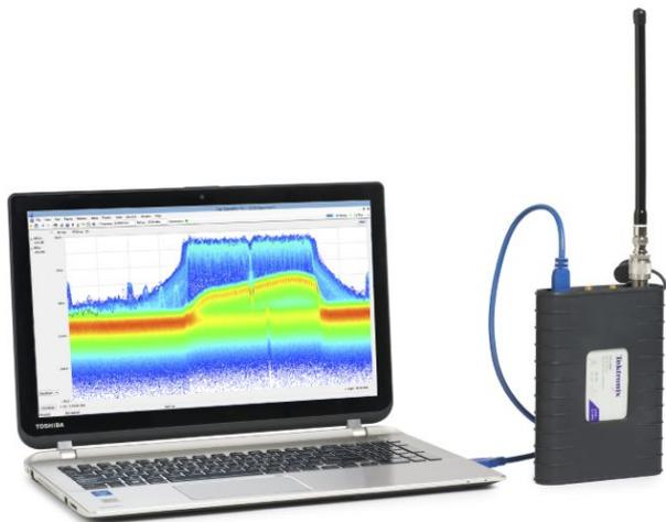
Анализатор RSA306, работающий вместе с программным обеспечением Tektronix SignalVu-PC™, которое устанавливается на отдельном компьютере, предназначен для анализа спектра в режиме реального времени, захвата потоковых данных и глубокого анализа импульсных сигналов в диапазоне частот от 9 кГц до 6,2 ГГц. Это позволяет снизить затраты и реализовать портативное решение, идеальное для использования в полевых условиях, на производстве и в научных исследованиях.
