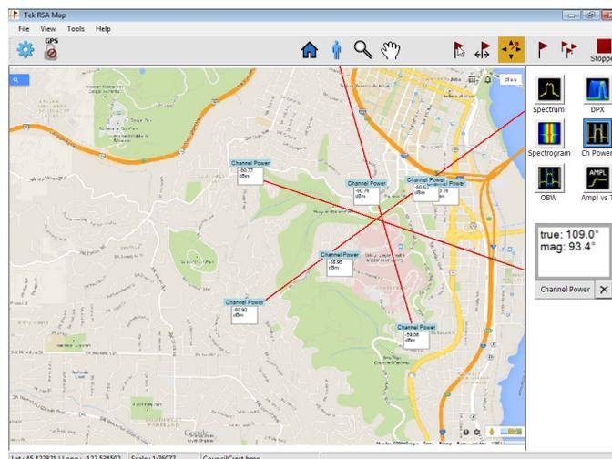
Опция MAP для ПО SignalVu-PC позволяет выполнять поиск источников помех и анализировать уровень сигнала. Местоположение источника помех определяется как функция азимута. Это дает вам возможность указать на карте линией или стрелкой направление антенны по результатам измерений. Также можно создавать и отображать метки измерений.
